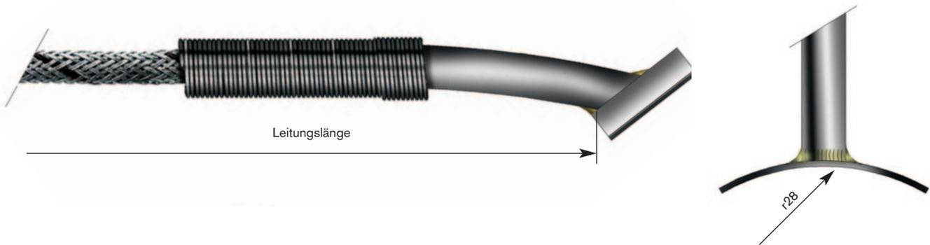
■ Für die Temperaturerfassung an Rohrleitungen, allgemein an zylindrischen Abmessungen sowie kunststoffverarbeitenden Maschinen. Befestigung über Rohrschelle. Das VA-Stahldrahtgeflecht der Anschlussleitung dient als mechanischer Schutz.
